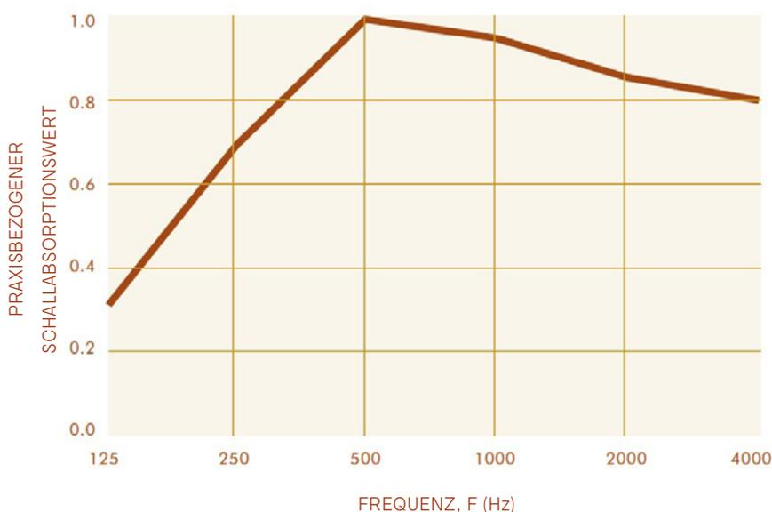
Wie in der Grafik zu sehen ist, erhält die 22mm-Platte, angebracht auf einer 45mm Unterkonstruktion und 45mm Mineralwolle, einen Schallabsorptionswert von 0,9 (MH).
