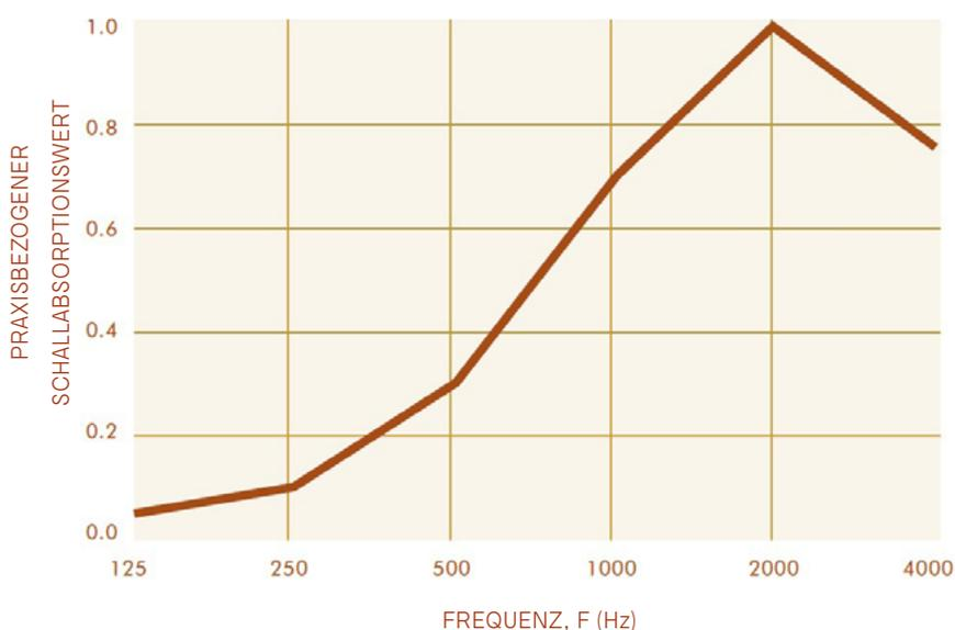
Wie in der Grafik zu sehen ist, erreicht die 22mm-Platte, die direkt an die Wand montiert wird, einen Schallabsorptionswert von 0,35 (MH).
