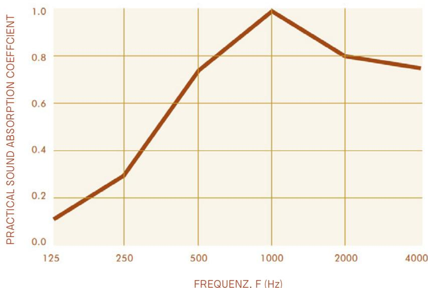
Wie in der Grafik zu sehen ist, erreicht die 22mm-Platte, die auf einer 45mm-Unterkonstruktion mit Hohlräumen zwischen den Latten montiert wurde, einen Schallabsorptionswert von 0,60 (MH).
